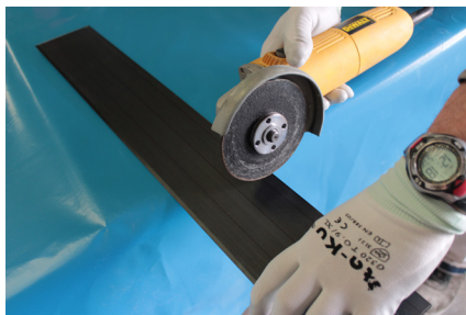
Faza 1: Rezanje tanke ploče FASSAPLATE CARBON S / HM / HHM
