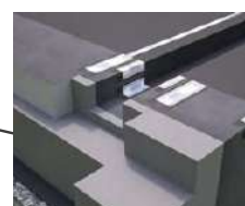
Detalj hidroizolacije obodnog oluka
