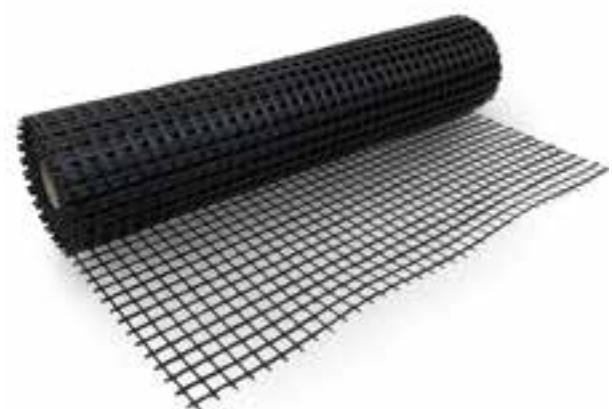
Armaturna mreža FASSANET ZR 350 od staklenih vlakana otpornih na lužine proizvod je nastao tkanjem niti od visokokvalitetnih staklenih vlakana s visokim udjelom cirkonijeva oksida na način da se ne gube početna mehanička obilježja ako se stavi u lužnatu okolinu. Uzimajući u obzir prirodu primjenjenih sirovina, armaturna mreža FASSANET ZR 350 otporna je na lužine i kad nema premaza za oblogu, za razliku od normalnih mreža.
